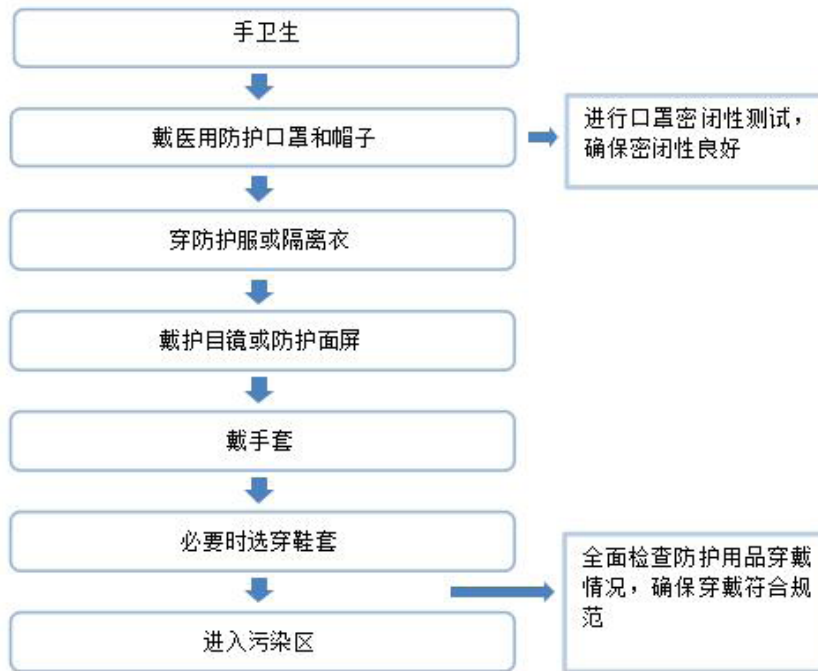
图 2-1 工作人员穿戴防护用品流程示意图
